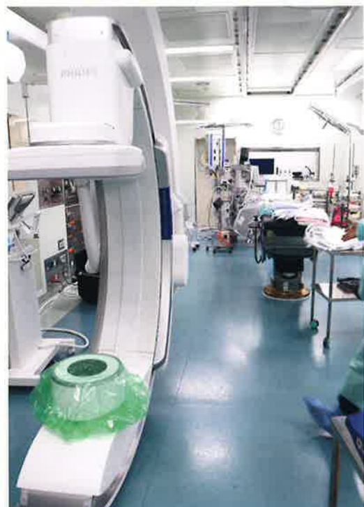
血管の中にカテーテルと呼ばれる細い管を挿入し、造影剤を注入して血管の状態を撮影する血管撮影装置
