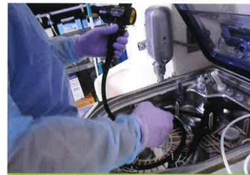
洗浄履歴が記録できる内視鏡洗浄消毒装置（オリンパス社製OER-3）で、スコープを高水準消毒
