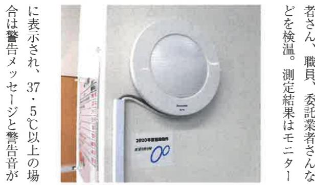
者さん、職員、委託業者さんなどを検温。測定結果はモニターに表示され、37・5℃以上の場合は警告メッセージと警笛音が鳴る仕様です。事務室でも遠隔でモニター画面を閲覧可能で、異常を検知した際は壁付け設置の子機が、警笛音とフラッシュ発光で知らせてくれます。
